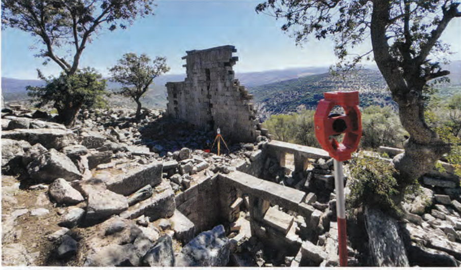
Tachymeteregüştützte Bauaufnahmearbeiten im Marktbau von Aigai / Pazar Yapısı'nda Total Station destekli rölöve çalışmaları
